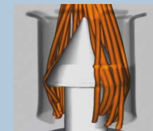
Figuur 2. Er ontstaat een groot contactoppervlak voor de draad – voorwaarde voor een hoogwaardige elektrische verbinding.
